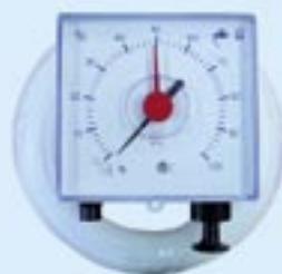
**Füllstandsanzeige**, arbeitet ohne elektrische Energie, für Erdtank. Pneumatisches Meßgerät mit Pumpe zur Handbedienung. Fernmessung bis 50 m. Stufenlos einstellbar für Tankhöhen von 1,0 m bis 2,5 m. Schlagfestes Kunststoffgehäuse mit 20 m Meßleitung und Befestigungsmaterial.
